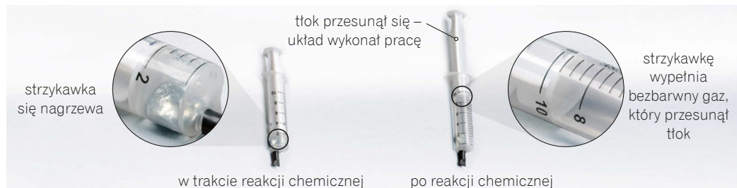
Fot. 66. Reakcja cynku z roztworem kwasu siarkowego(VI) \text{Zn} + \text{H}_2\text{SO}_4 .
